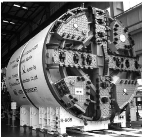
写真は泥土圧シールド
